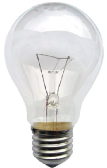
يعمل مصباح الإضاءة، وهو أحد التطبيقات الأولى على الكهرباء عن طريق التسخين بحرارة جول: فالتيار المار خلال المقاومة يولد الحرارة.
