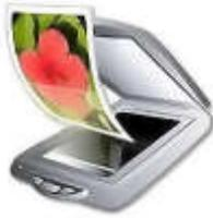
يستخدم الماسح الضوئي في إدخال الرسومات والمستندات المطبوعة والمكتوبة يدويا وبأحجام مختلفة وتحولها الى صور رقمية (Digital Images) أي هو جهاز أدخل يقوم بتحويل الصور أو الرسومات أو الأشكال أو النصوص لمعلومات إلكترونية يمكن استخدامها بواسطة الحاسوب.
