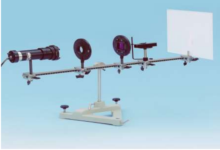
شكل (1) يبين منظومة حيود الضوء باستخدام اشعة الليزر
