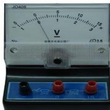
جهاز قياس الفولتية (الفولتيميتر)
