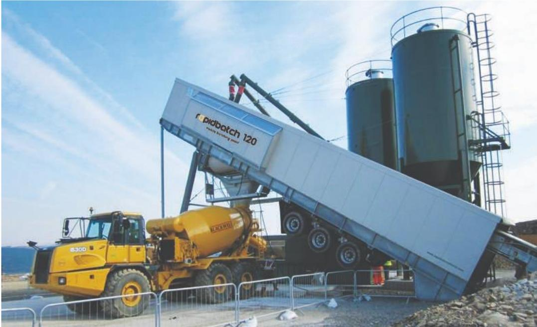
في هذه الخلاطات (الكبيرة الحجم) يستمر التحميل والخلط والتفريغ حتى اكتمال العمل أو حدوث انقطاع للعمل. يتم تحميل المواد بشكل مُستمر بواسطة مغذيات لولبية. تستخدم الخلاطات المستمرة في المشاريع الكبيرة جدًا مثل السدود والجسور وتشبيد المباني الشاهقة.
