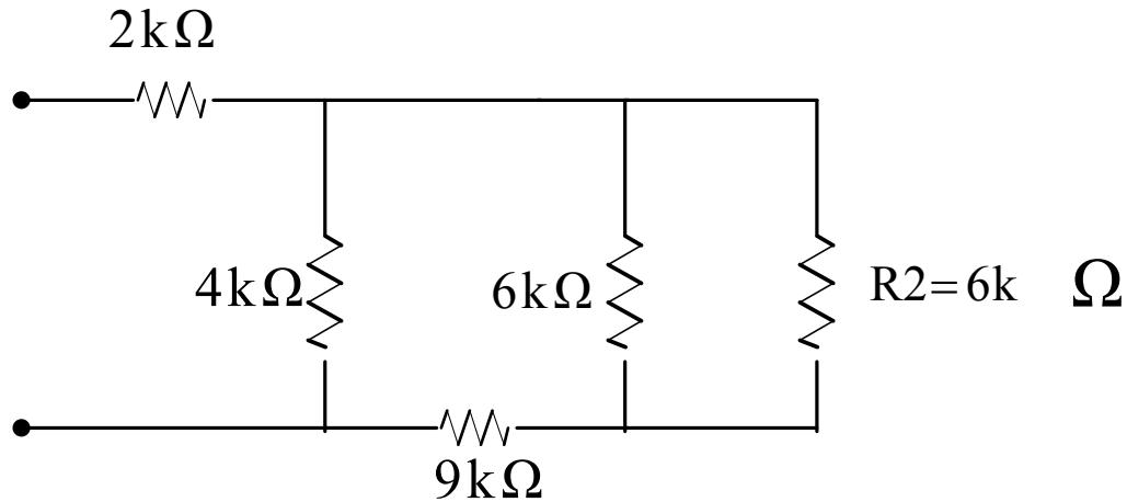
$$R_3 = (6\text{k} // 6\text{k}) = 3\text{k} \Omega$$
