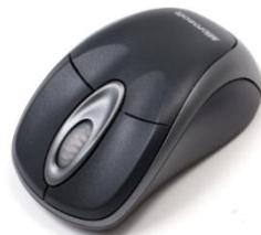
٣- **الماوس الليزري Laser Mouse** وهو أحدث انواع الماوس ، هذا النوع أعلى دقة وسعرا من الماوس الضوئي والدقة العالية لن يحتاجها الا المصممين المحترفين وأصحاب الألعاب السريعة والدقيقة
