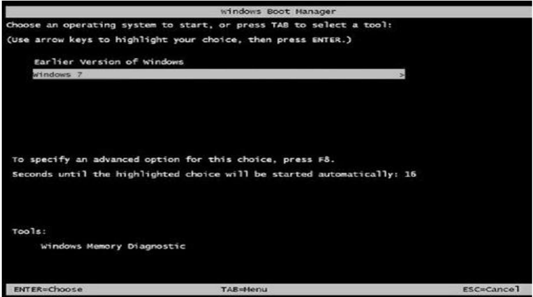
تنتهي عملية الإقلاع بمجرد تسلم نظام التشغيل المسؤولية للتحكم، مع ملاحظة أنه في أجهزة الكمبيوتر الحديثة لا تستغرق عملية الإقلاع وقتًا، ويتم بواسطتها الاختبار الذاتي وتهيئة المكونات ثم إيجاد وتحميل نظام التشغيل، وهي تعتمد على برنامج يعرف بـ"محمل الإقلاع أو " "Bootloader وهو المسئول عن تحميل باقى أجزاء نظام التشغيل بعد نجاح اختبارات التشغيل الذاتي.
